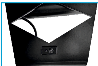
LASER DO POMIARU SZEROKOŚCI OBRĘCZY
