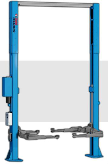
CAPACITY: 8000 kg POWER SUPPLY: 400V/50Hz MOTOR POWER: 3,5 kW LIFTING HEIGHT: 120 - 2165 mm TOTAL HEIGHT: 5850 mm CLEARANCE: 2800 mm 2-STAGE ARMS: 770 -1130 mm OIL PRESSURE: 25 MPa <75 dB NOISE LEVEL: WEIGHT: 2065 kg
