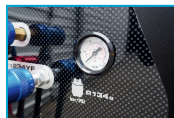
MANOMETR ZBIORNIKA R134a i HFO1234yf
