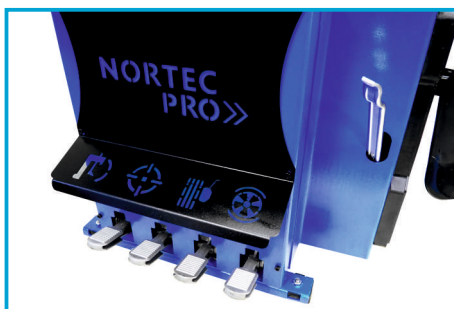
2 PRĘDKOŚCI OBROTOWE STOŁU STEROWANE PEDAŁEM
