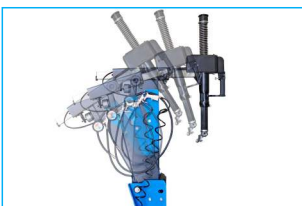
Pneumatycznie odchylenie ramię szersze u podstawy
